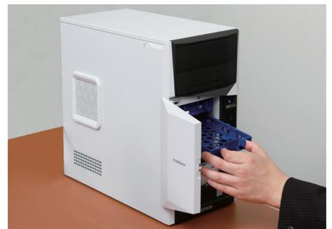
HDDフロントアクセス対応モデルは、SOHOなどサーバーが無い場合でも、ストレージの増設が容易だ。災害時にHDDだけを持ち出せるなど意外なメリットも多い。
