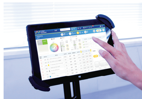
計測した車体の色を解析し、原色の組み合わせを決定。 勘だけに頼らない調色を実現。
