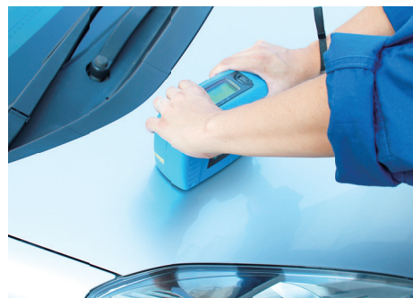
測色計で車体の色を計測。部位によっても色の劣化が違うため、人とシステム、両方の力が求められる。
