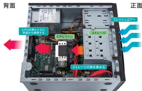
サーバーの場合、ストレージの熱を効率的に冷却することが重要となるため、筐体前面の通気孔からフレッシュエアを吸い込み、ストレージの熱を集めて、CPUファンで筐体背面から排熱するエアフローを設計。ホコリの流入を最小限に抑えるため筐体側面の通気孔を塞ぎつつ、排熱性の共存を実現している。
