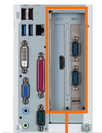
《拡張スロット》 左：HDMIポート増設時 右：シリアルポート増設時
